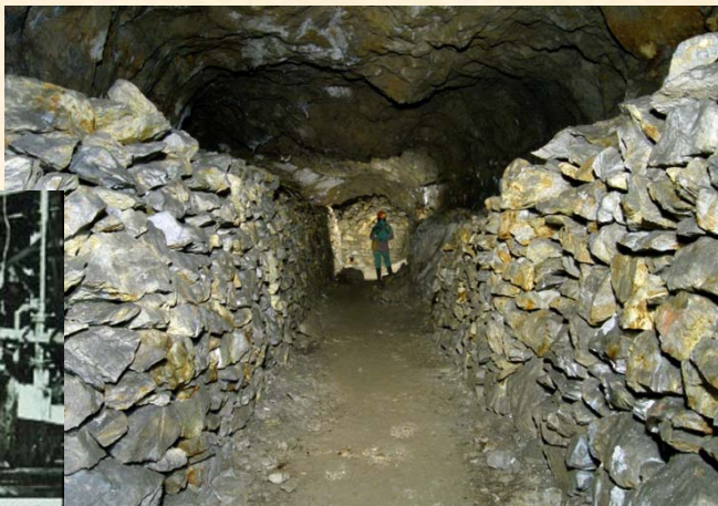
Passage bordé de remblais dans un chantier du niveau Saraceni - B. ANCEL 2009
